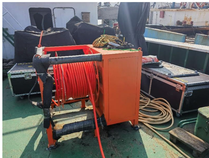
发射缆+电动绞车 (带电池)
